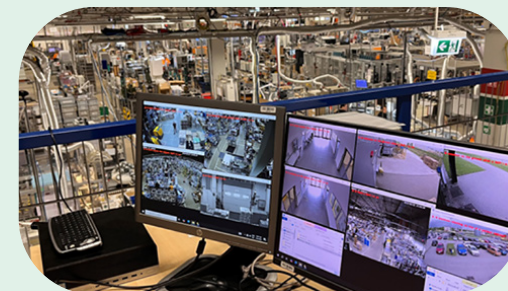
波蘭貝津(Będzin)「視覺感知」AI系統可檢測跌倒、推車傾倒及其他異常活動
